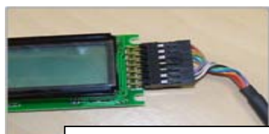
LCD を表側から見たケーブルの接続写真 (赤色が上側になってます)
